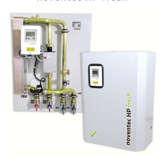
Die "noventec HP fresh" Frischwasserstation dient zur hygienischen und energiesparenden Trinkwassererwärmung und ist in verschiedenen Varianten (je nach benötigter Zapfleistung) erhältlich. Mittels eines Kreuzstom-Wärmetauschers wird heißes Wasser aus dem Pufferspeicher gegen kaltes Trinkwasser getauscht. Durch das Durchlaufprinzip muss das warme Trinkwasser nicht bevorratet werden, sondern es wird dann erzeugt, wenn es benötigt wird.
